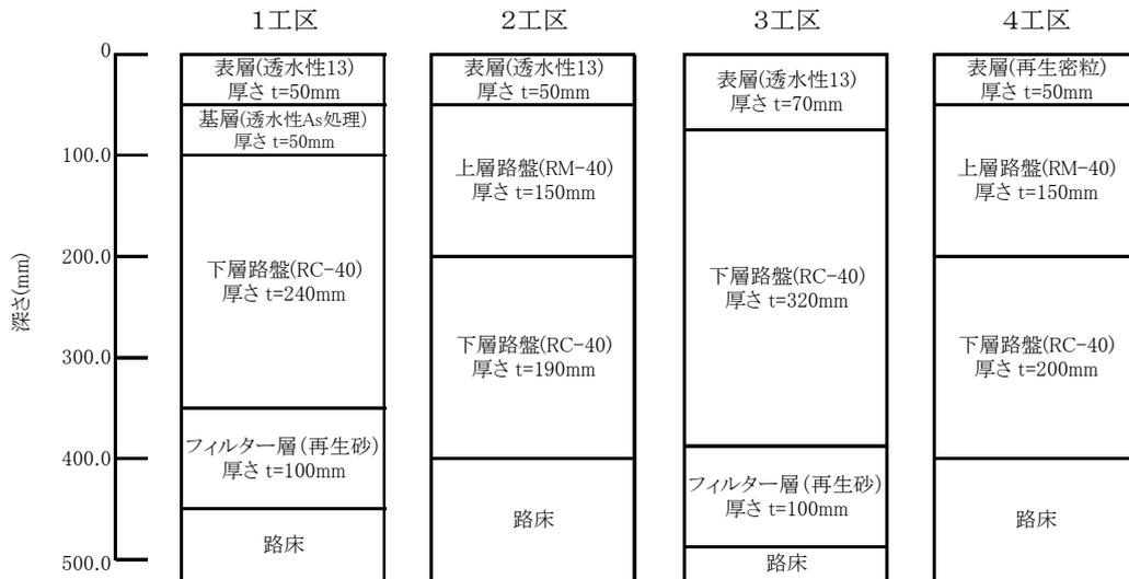
図-1 舗装構造図
