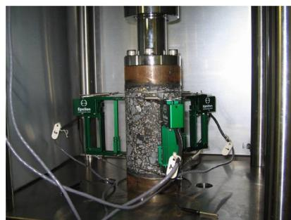
写真-1 push-pull型疲労試験装置
