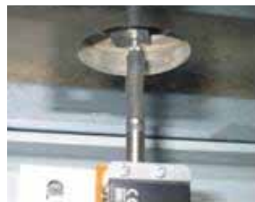
写真-2 ナットと変位計の接触状況
