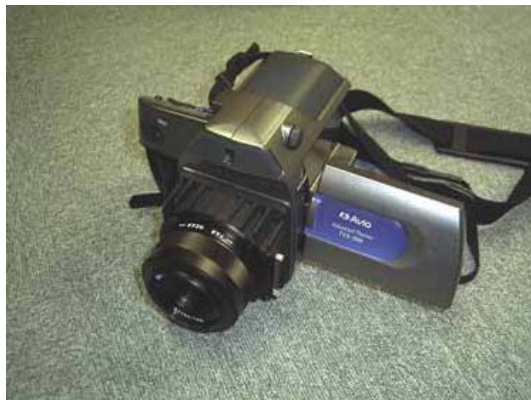
写真-2 赤外線サーモグラフィ
