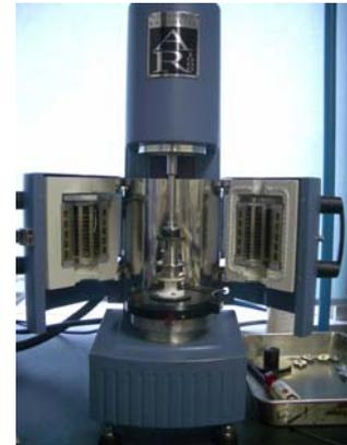
図-3 試験に用いたDSR試験装置
