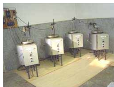
写真-1 室内貯蔵パイロット装置 SSM-Lab タンク（ラボタンク） 8)
