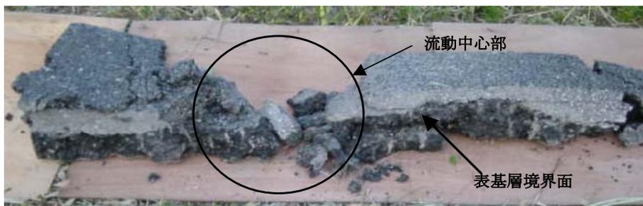
写真-2 側方流動発生箇所断面写真
