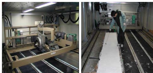
写真-4 走行試験装置(左)と圧雪路面作製状況
