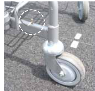
写真-3 加速度計取付け状況
