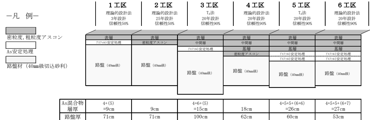
図-1 試験施工断面図
