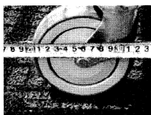
写真-9 大型カート車輪(硬質ゴム製)
