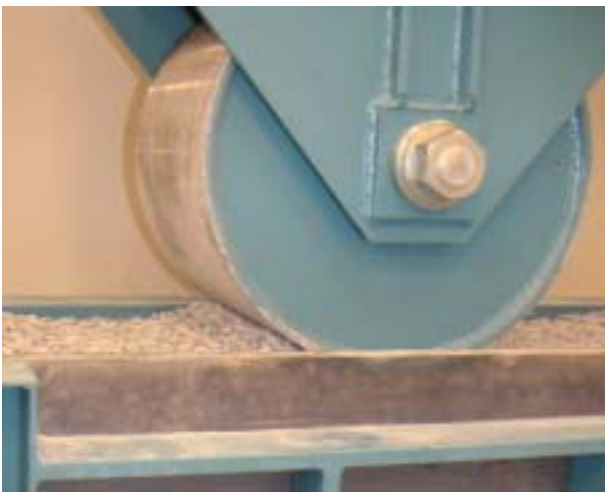
写真-4 ローラー近傍の局所的な破壊による粒子移動の状況
