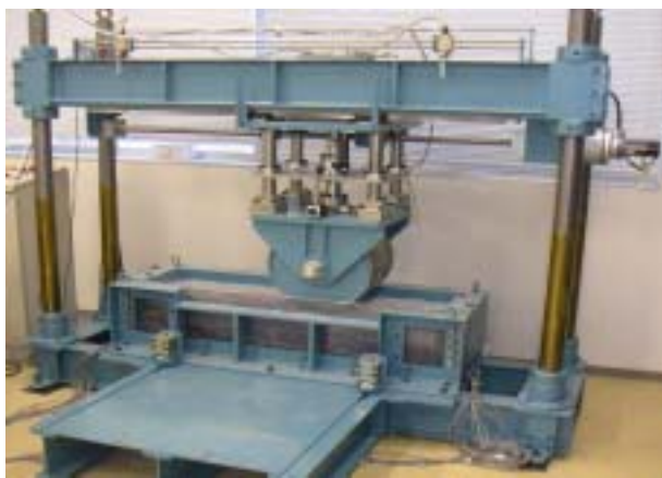
写真-1 移動ローラー載荷装置
