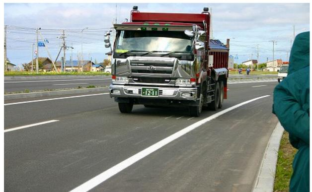
写-2 走行車両による舗装体ひずみの計測状況
