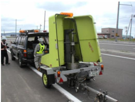
写真-1 FWD たわみ計測状況
