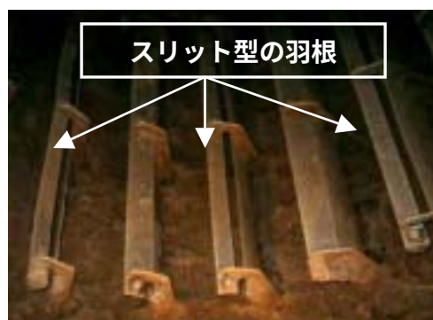
写真-1 改良後の再生加熱ドライヤー内の羽根装着状況（スリット入りを交互に配置）
