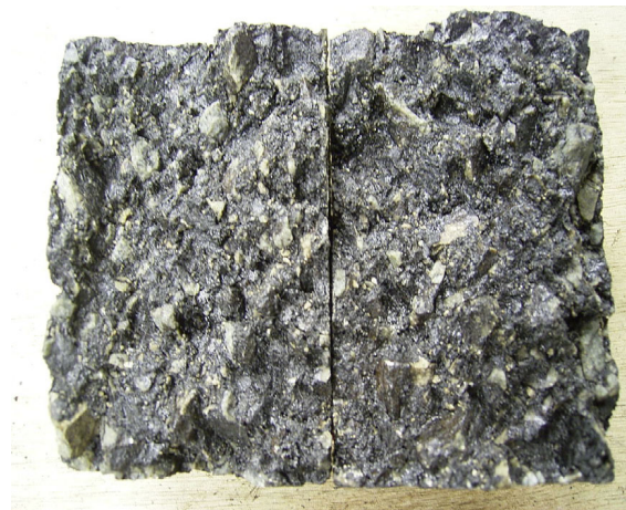
写真-6 圧裂試験 (25℃) 後の供試体破断面
