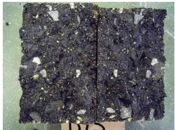
写真-5 圧裂試験 (5℃) 後の供試体破断面
