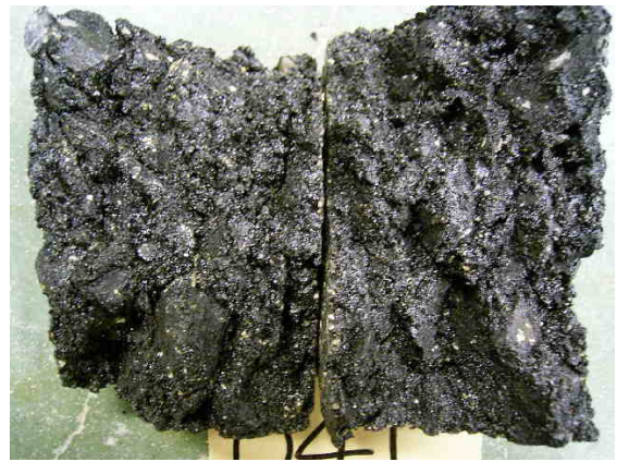
写真-4 マーシャル安定度試験後の供試体破断面
