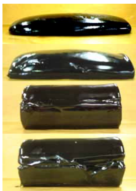
写真-3 分散形態Ⅲの分離状況 (分離無し)
