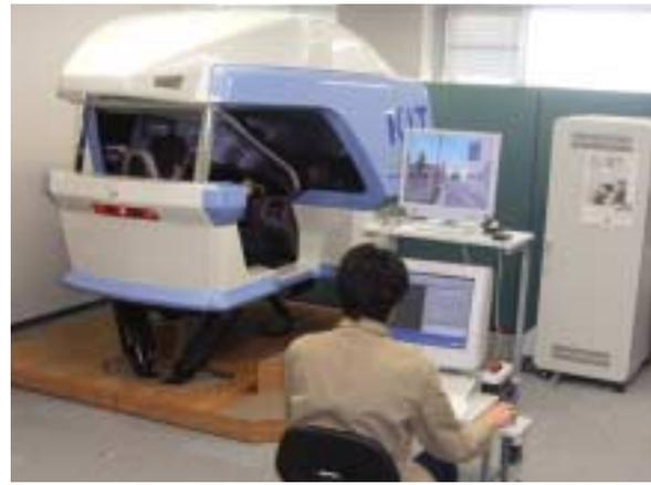
写真-1 ドライビングシミュレータ
