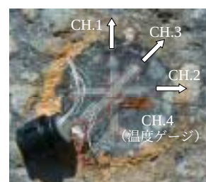
写真-1 SU-cell の設置状況
