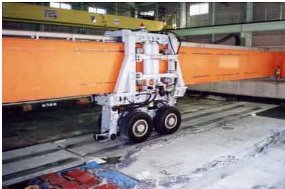
写真-3 走行載荷試験の状況
