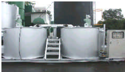
写真-1 特殊バインダ製造投入装置
