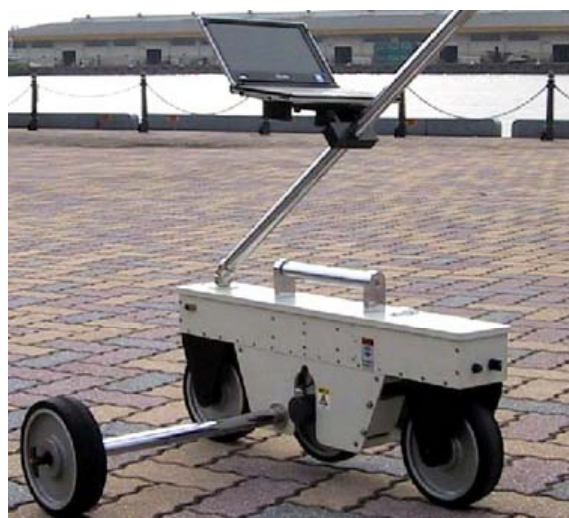
写真-1 縦横断形状測定装置の外観
