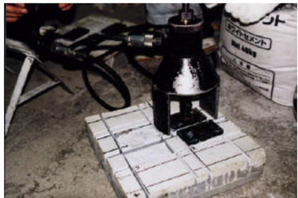
写真-1 付着試験状況
