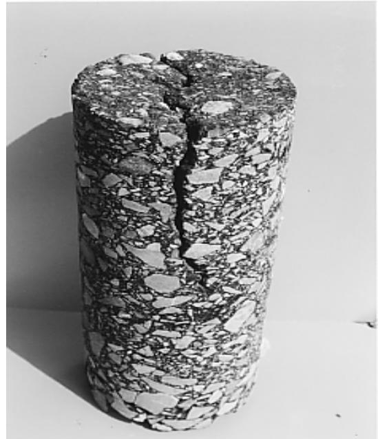
写真 - 2 トップダウンクラック発生箇所から採取したコア
