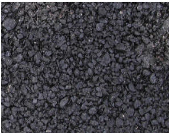
写真 - 1 プラスチック混入なし混合物表面性状
