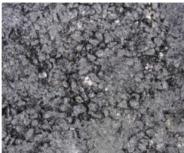
写真 - 2 PE-2 8%混入混合物表面性状
