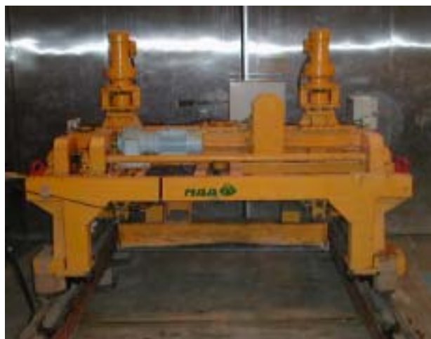
写真-1 ミニフィニッシャによる施工性評価試験
