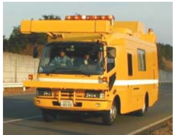
写真-1 路面性状測定車
