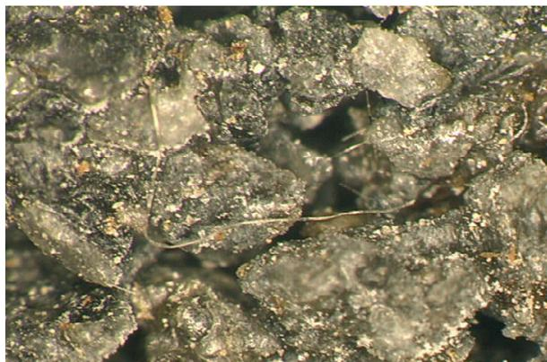
写真-1 砕砂舗装表面 (100倍)
