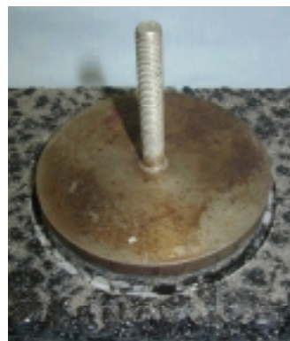
写真-8 骨材の付着試験治具設置状況
