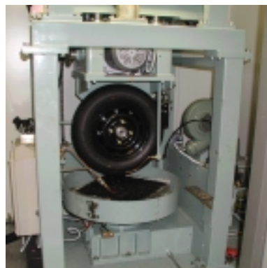
写真-1 骨材飛散抵抗試験機
