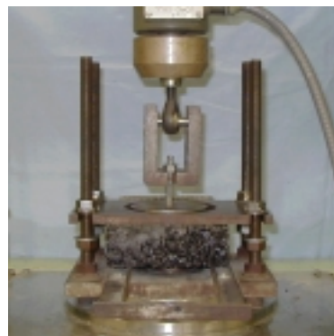
写真-9 引張り試験機
