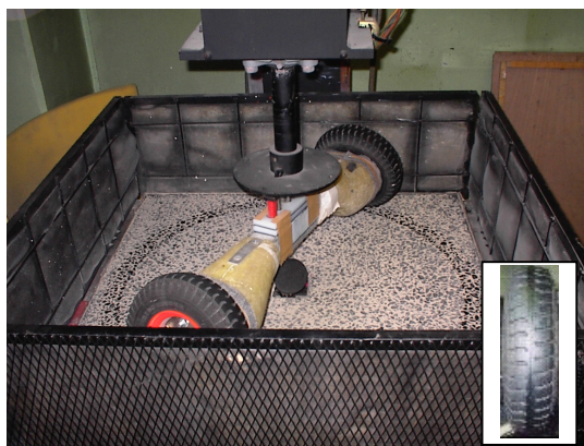
写真-1 騒音シミュレータ外観と使用タイヤ
