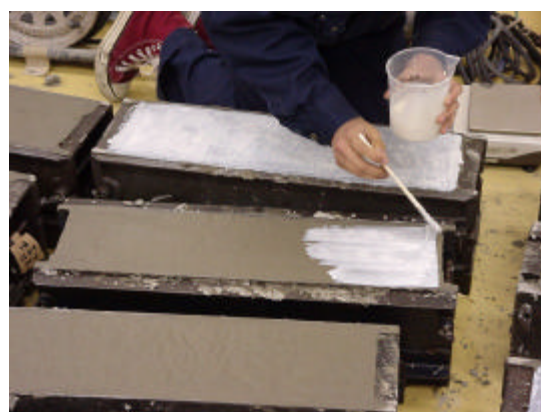
写真-1 供試体打設面への養生剤塗布
