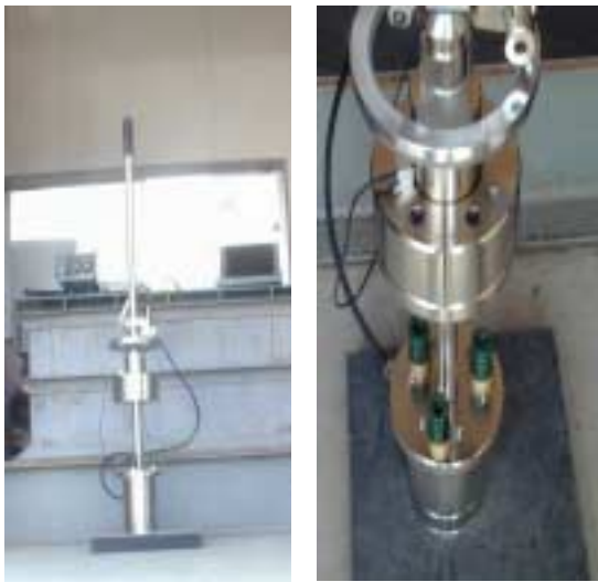
写真-1 ゴム板上の小型FWDと緩衝材
