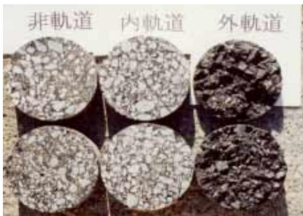
写真-2 載荷試験後のレベリング層の切取供試体 (外軌道は剥離によりレベリング層の下部が剥脱している。他は採取後にレベリング層下面をカッターにより整形済)
