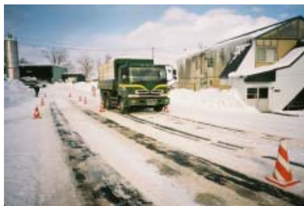
写真-1 制動実験状況
