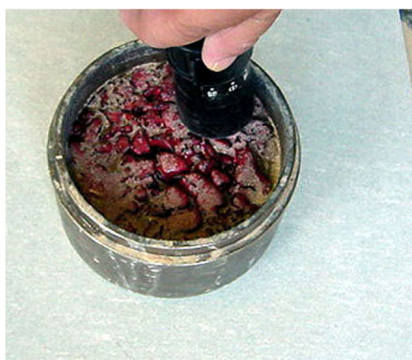
写真－3 空隙詰まり物質除去作業状態
