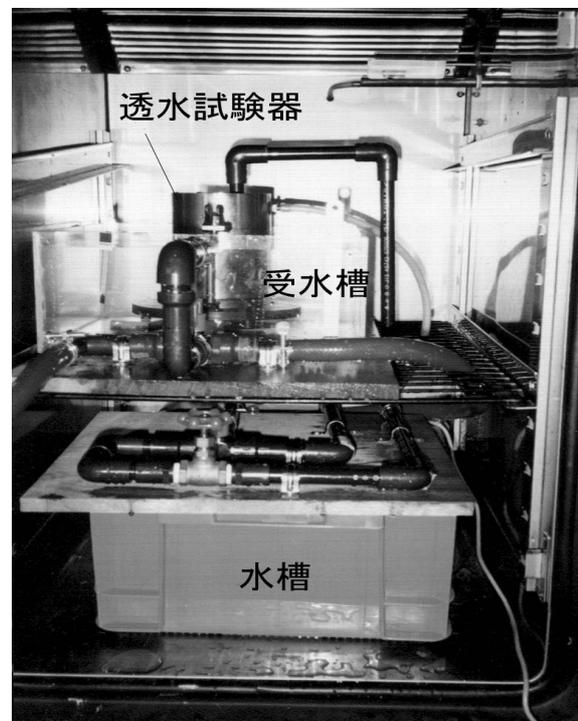
写真-3 試作した透水試験器
