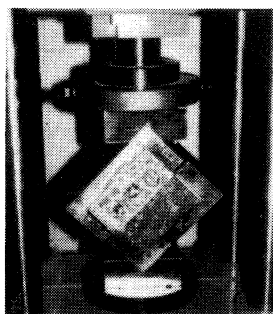
写真-1 界面せん断強度試験
