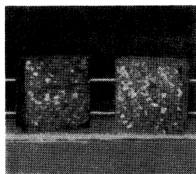
写真-1 界面せん断強度試験
