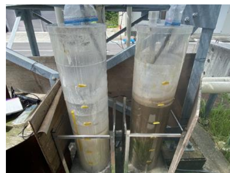
図1 連続処理実験装置
