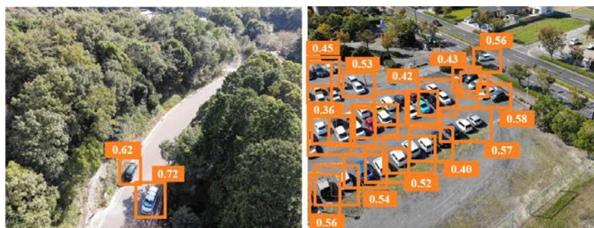
図3 ドローン画像の車両検出結果（左：五剣山，右：香川大学）
