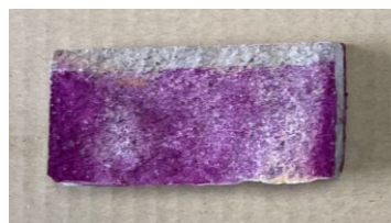
写真-1 フェノールフタレイン溶液散布の状況
