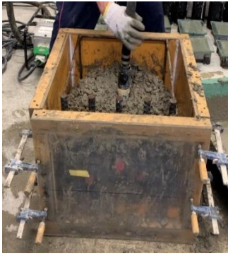
写真—5 模擬型枠
