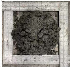
写真-2 W/(C+F)35% 落下運動後の様子
