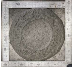
写真-4 W/(C+F)40% 落下運動後の様子
