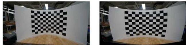
図-5 広角レンズの歪み補正前(左)と補正後(右)画像
