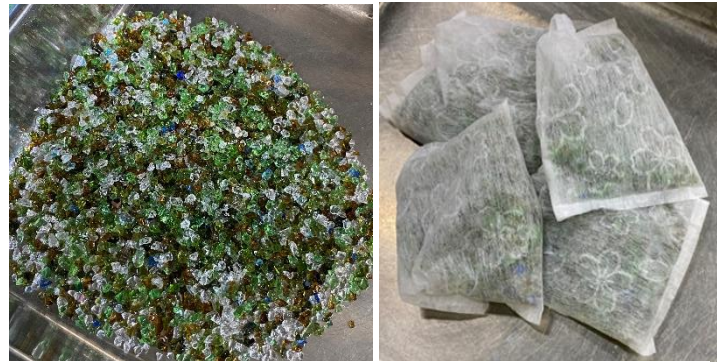
図1 ガラス礫と作成した土嚢
