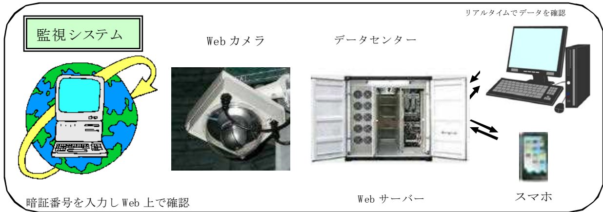
図-2 遠隔監視カメラシステム
