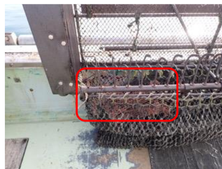
図-1 小型底びき網の漁具(桁枠)および繊維ごみ採取用網(図中の赤色四角箇所)
