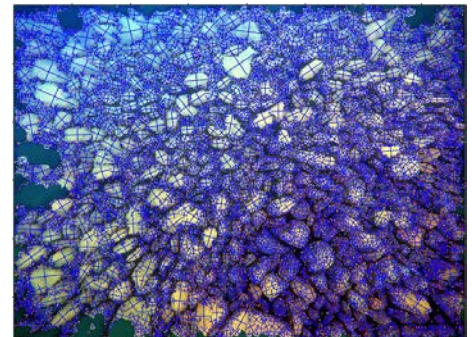
図-4 図-3をBASEGRAINで解析した結果
