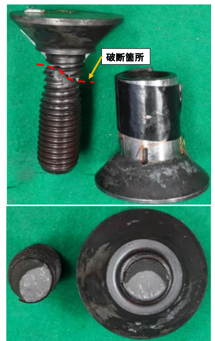
図-4 実験後の供試体の様子
