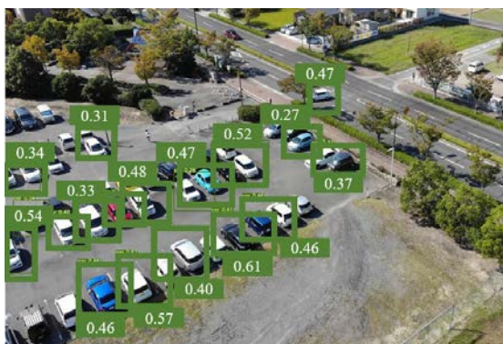
図4 車両抽出結果（駐車場）
