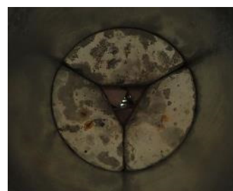
図3 鋼管挿入時の断面の様子
