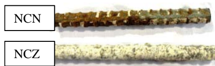
図-5 乾湿繰返し 196 日後の鉄筋腐食状況例
